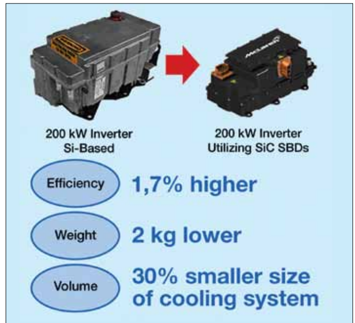
Bild 4. Leistungssteigerung und Größenreduzierung der Traktionswechselrichter für Formel-E-Rennwagen durch Einführung der SiC-Schottky-Dioden-Technologie.
