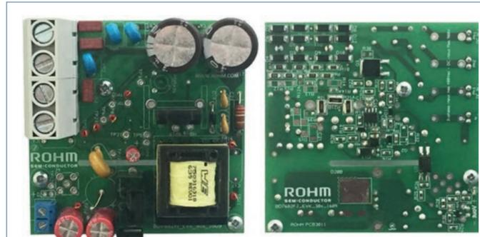
Bild 4: Evaluation-Board für eine SiC-basierte Hilfsversorgungslösung.
