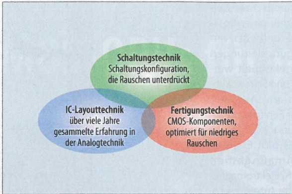
Bild 3. Um das Rauschen bei Operationsverstärkern wirksam zu reduzieren, hat Rohm drei Techniken zu einem Optimum kombiniert. Halbleitertechnik, Fertigungstechnik und Schaltungstechnik. (Quelle: Rohm)
