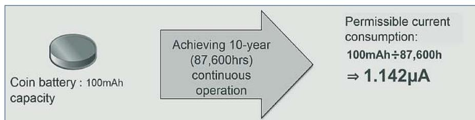
**Bild 1:** Voraussetzungen, um zehn Jahre Betrieb mit einer einzigen Knopfzelle zu erreichen.
