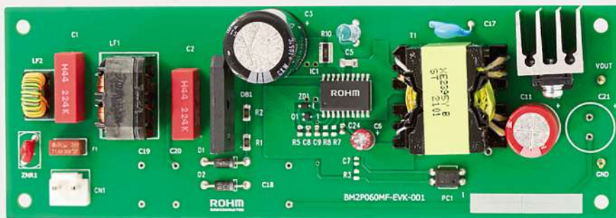
Bild 7: Das Evaluierungsboard BM2P060MF-EVK-001 zu den neuen Wandlern BM2P06xMF-Z.
